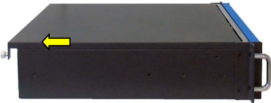
Abb. 14: Durch diese Bewegung werden die Fixierungslaschen des Deckels, aus den Deckelhaltetaschen des Gehäuses herausgezogen.
