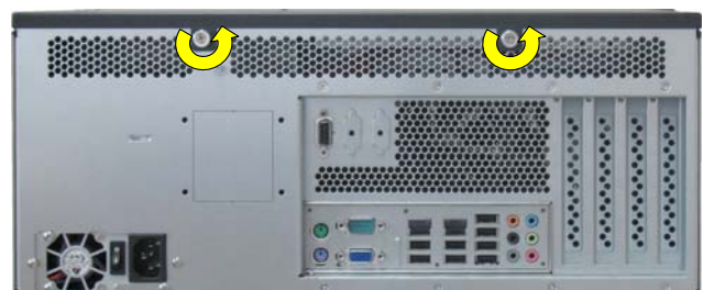
Fig. 25: Lösen der Rändelschrauben an der Rückseite
