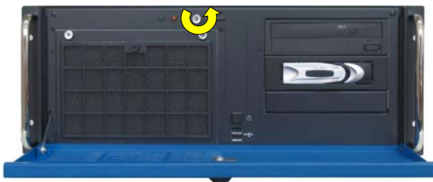
Fig. 24: Lösen der Deckel-Anziehschraube an der Frontseite
